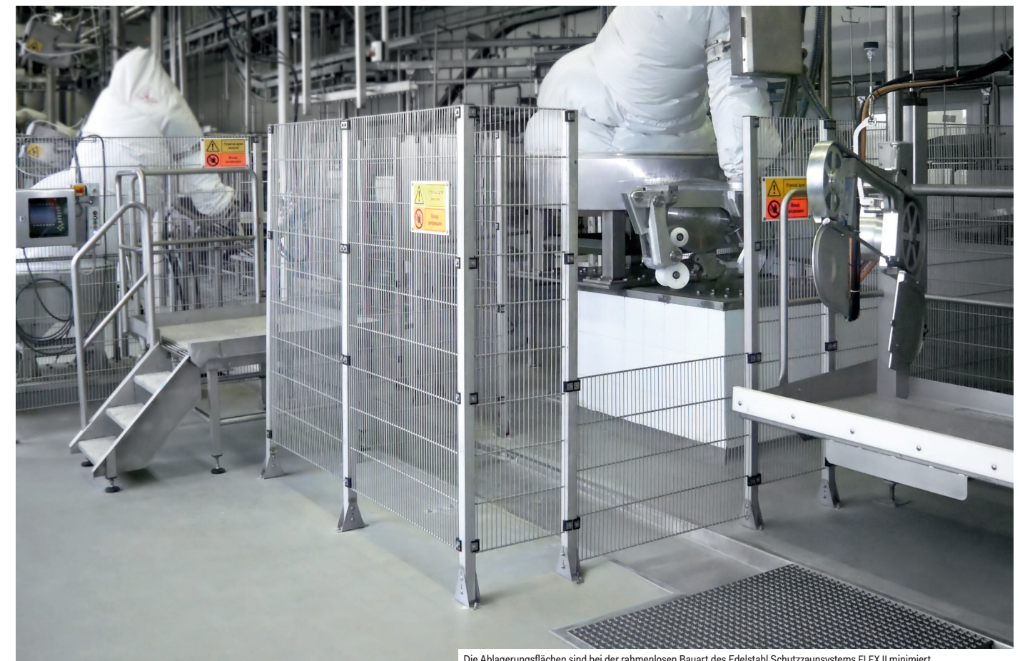
Die Ablagerungsflächen sind bei der rahmenlosen Bauart des Edelstahl Schutzzaunsystems FLEX II minimiert
